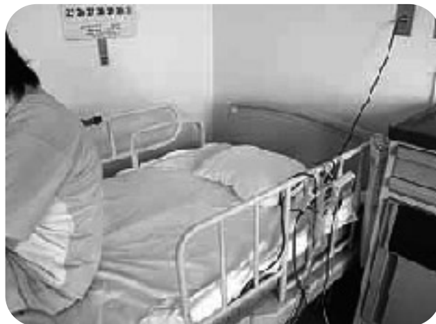
患者様が起き上がるとセンサーが作動し、ナースコールで知らせます。
